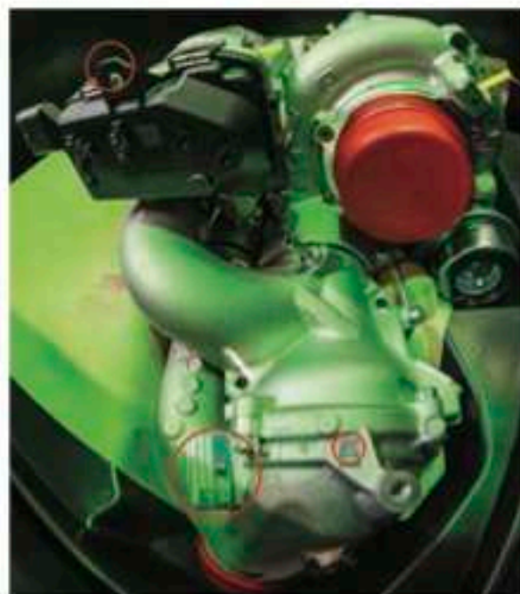
Aus 3,5 m Entfernung erfolgt präzise die Detektion des 3 mm breiten Kunststoffsteiges, des Typenschilds und des nur etwa 5 x 5 mm großen Datamatrix-Codes.
